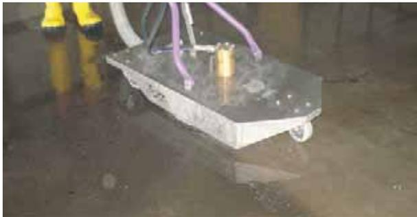
Die Verschmutzungen werden durch unseren SanTec-CleanScater ohne den Einsatz von chemischen Reinigungsmitteln an der Oberfläche abgelöst und über eine integrierte Schmutzwasserabsaugung abgeleitet.
